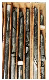
ANED-02. Copper Mineralisation at ~151m<sup>2</sup>
