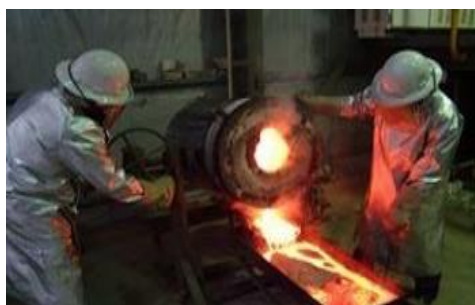
Process facility gold pour
