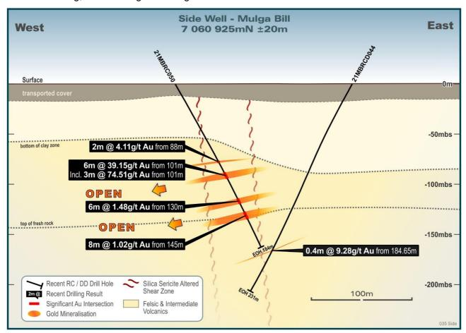
FIGURE 1: FLAT HIGH-GRADE QUARTZ-SULPHIDE VEINS INTERSECTED IN 21MBRC050.
