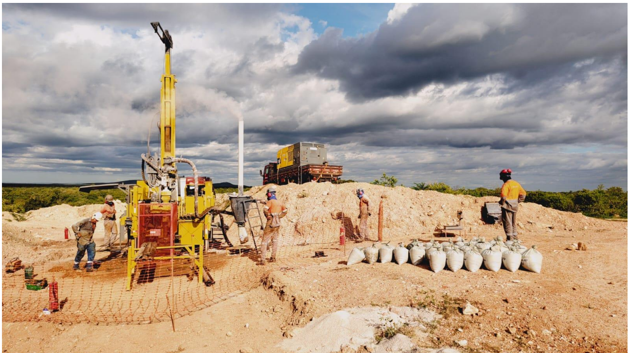
Figure 2: First vertical RC Hole at Bom Jesus de Baixo pit
