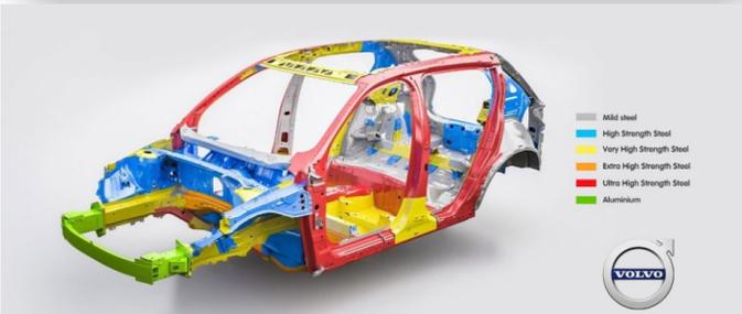
ADVANCED HIGH STRENGTH STEEL UTILISATION IN VOLVO SUV<sup>3</sup>
