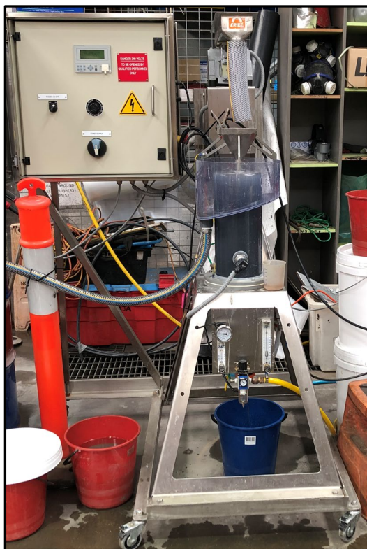
Figure 2. Laboratory Scale Eriez Hydrofloat in operation at ALS Metallurgy
