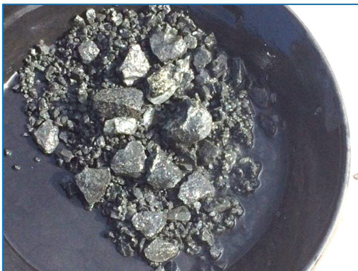
Sulphide lode 3.86g/t Au (BBRC0012; 193m-194m)
