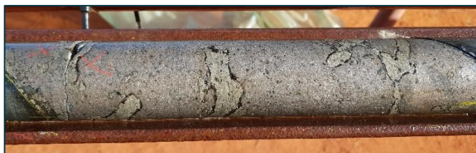
18EMDD001: Pyrrhotite, pyrite, +/- chalcopyrite mineralisation
