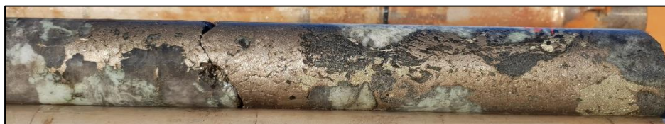
18EMDD002: Pyrrhotite, chalcopyrite, +/- pyrite mineralisation
