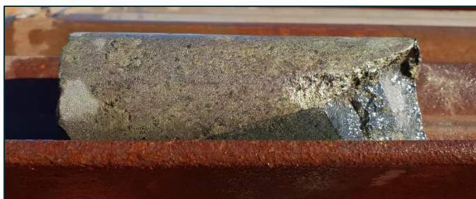
18EMDD001: Pyrrhotite, chalcopyrite +/- pyrite mineralisation
