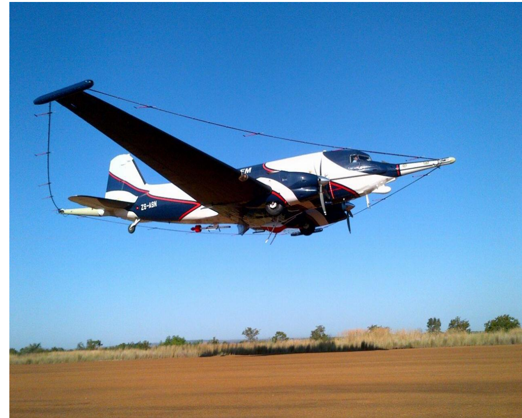
12,000 line km airborne EM survey underway
