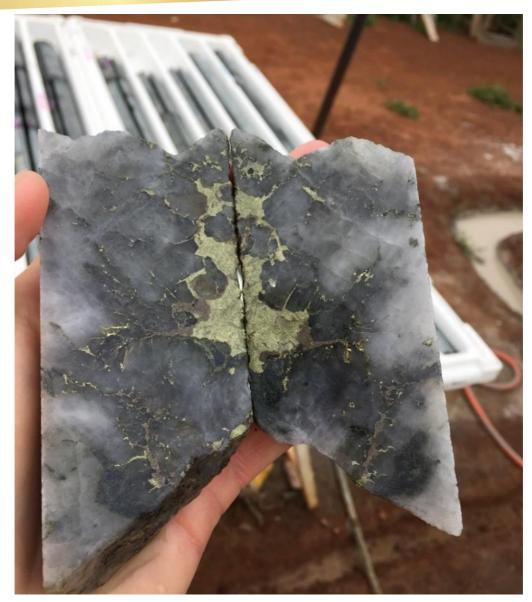
FIGURE 4 – RYDD080 DIAMOND CORE SHOWING VISABLE GOLD & RETURNING 776g/t Au
