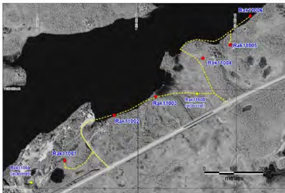
Figur 1. Borrhål som borrats. Kontroll har skett av alla borrade hål som ligger på land, dvs. Rak11001, Rak11003-5. Hålen Rak11002 & Rak11006 borrades på sjön.
