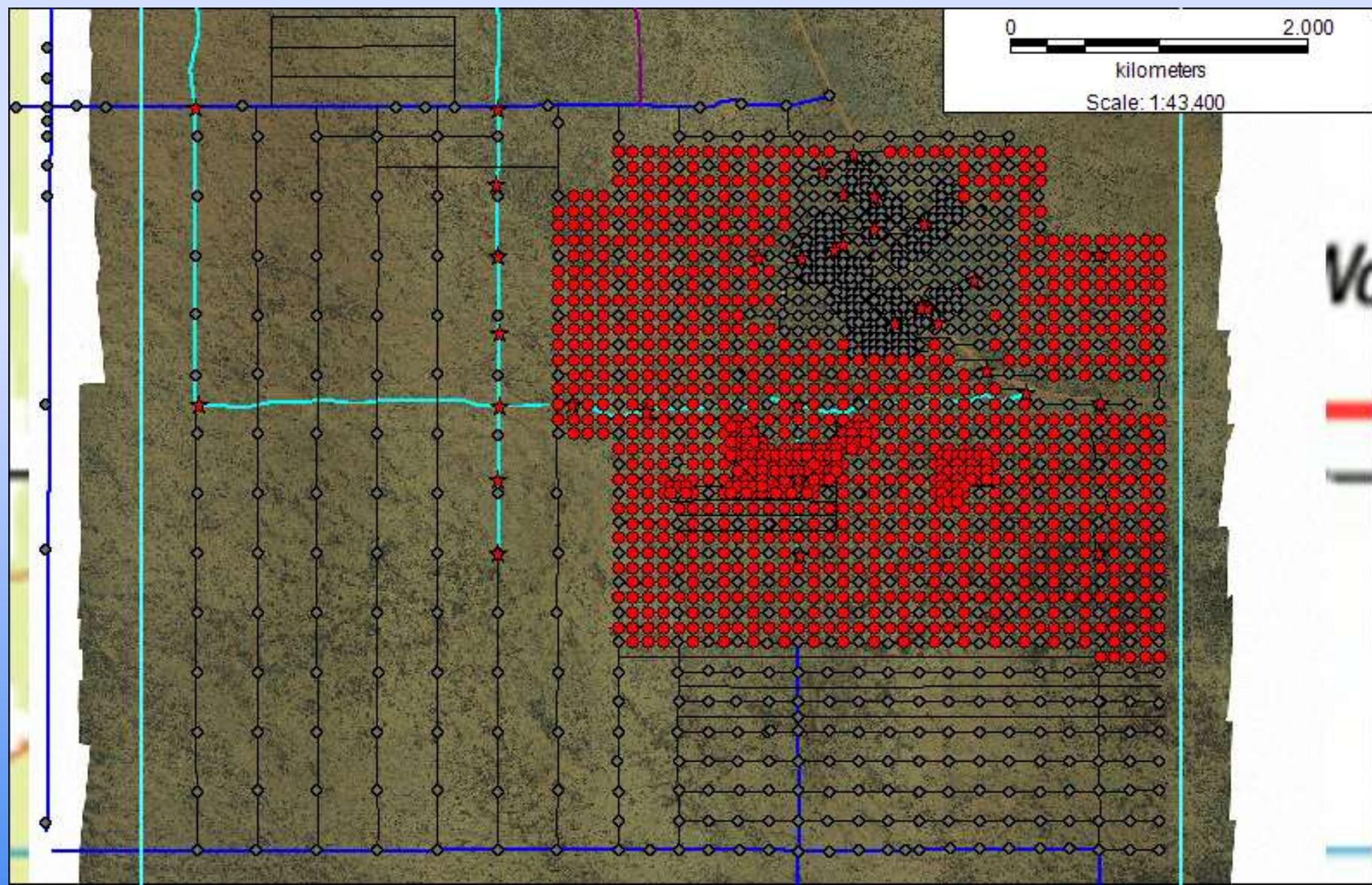
资源估算钻探在2012年9月完成。总计2082 RC钻孔，共61,221米。总计32金刚石取心
