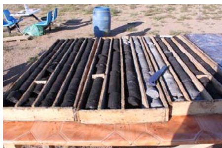
Har Toirom Deposit drill core
