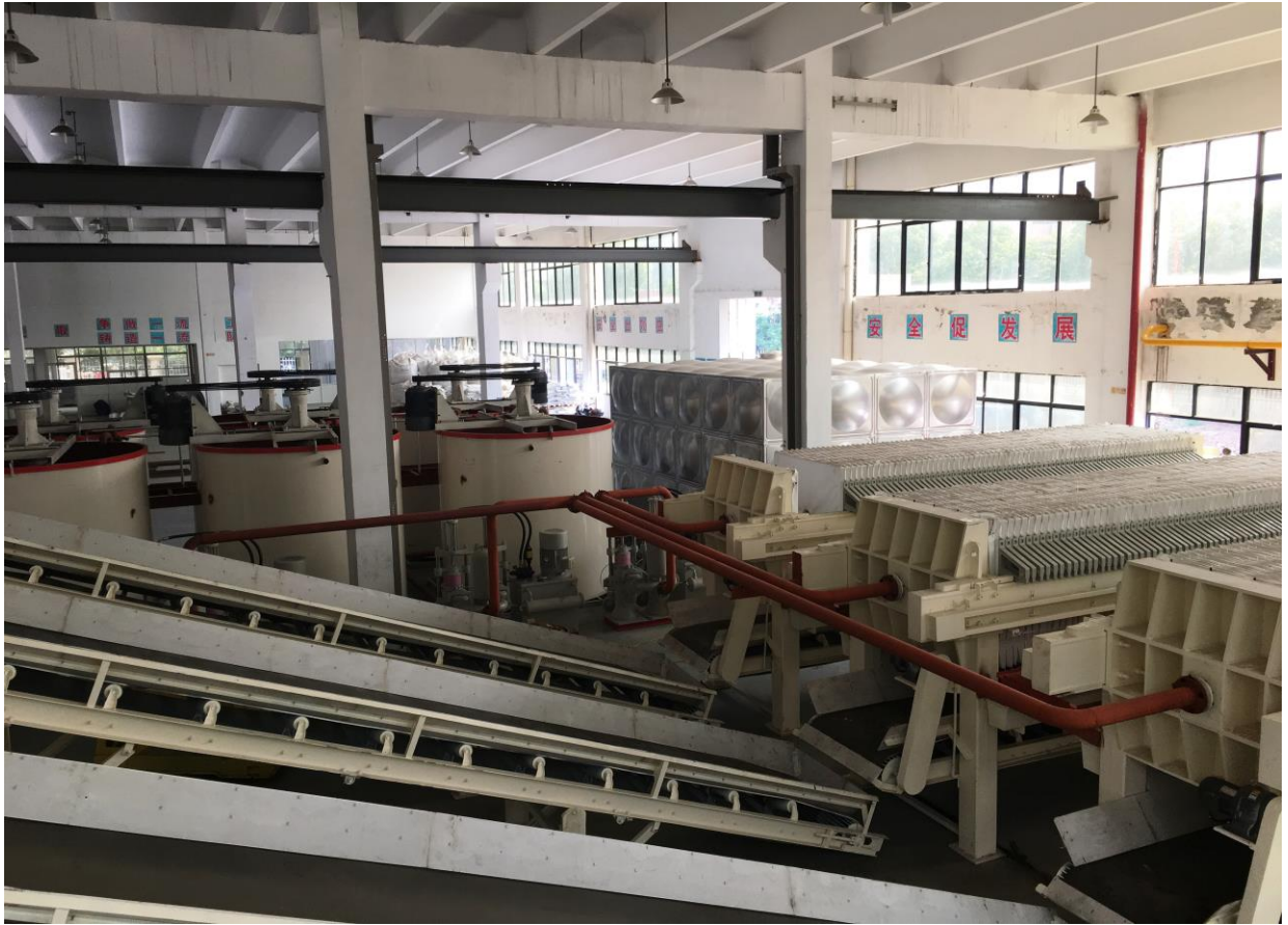
长兴厂房 - 搅拌机, 压滤机和输送器到燃气烘干机
