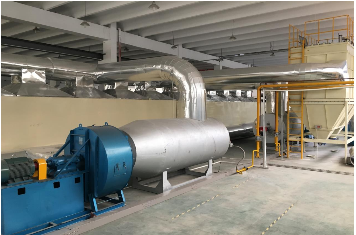
长兴厂房 - 燃气烘干机及套袋设备
