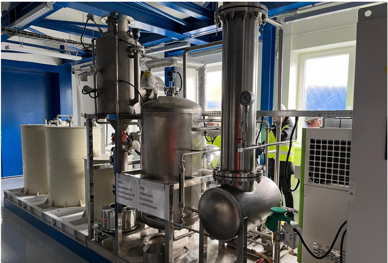
**Photo 8. HPMSM Crystallisation Module**
