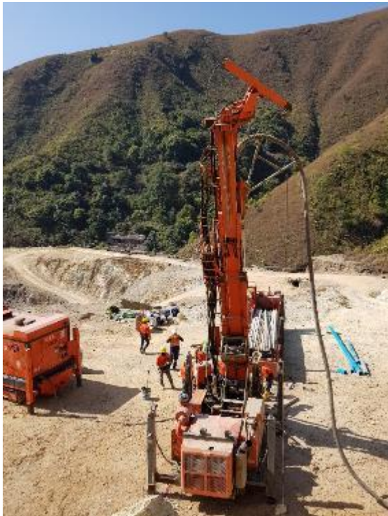
RC Drilling Rig at Bawdwin
