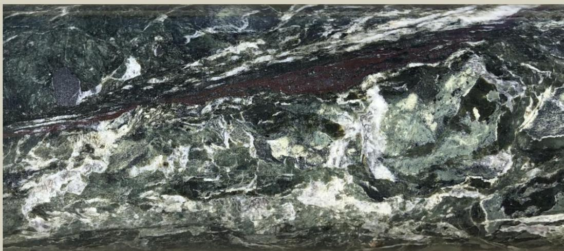
Magnetite-hematite vein in serpentinite breccia. 103.3m.
