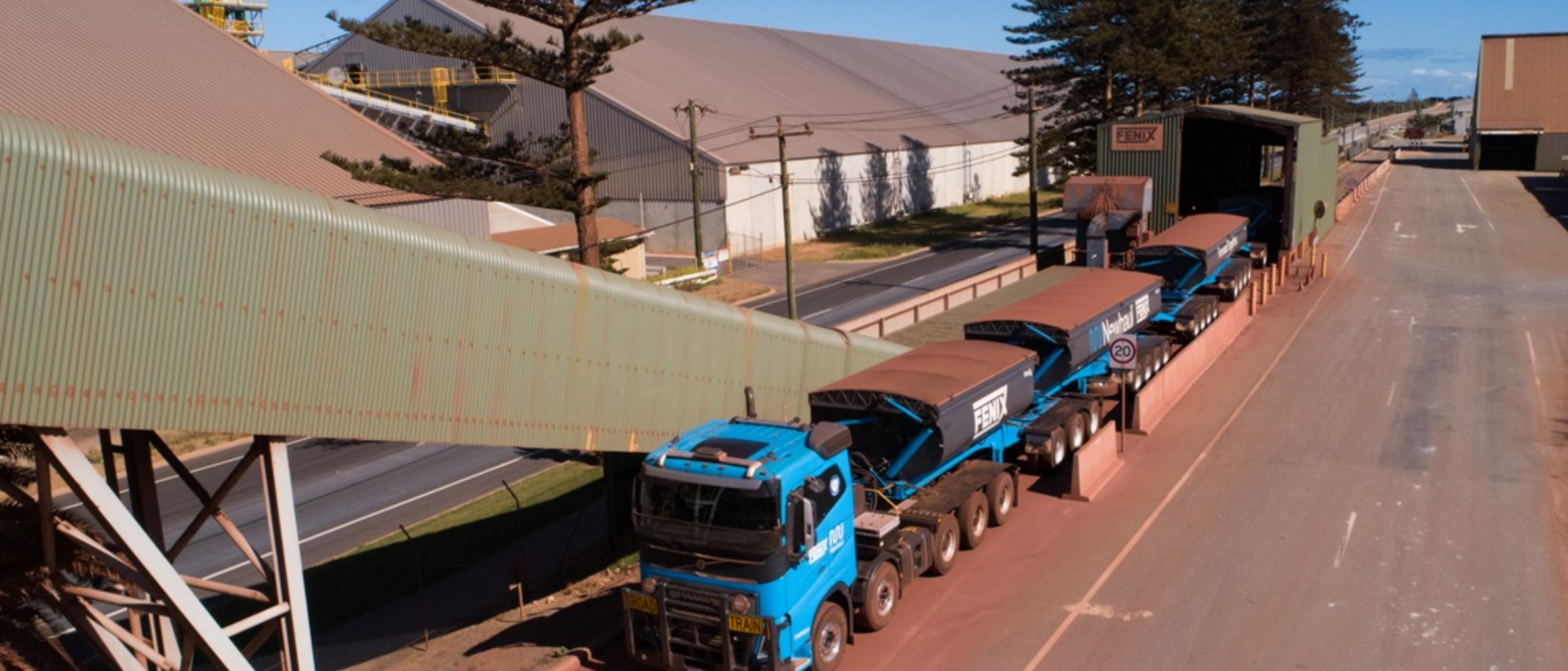
**SIDE TIPPER DUMPING & CONVEYOR SYSTEM DELIVERS INTO FENIX STORAGE SHED.**
