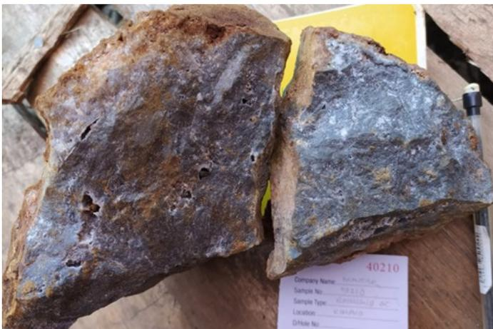
Photo1: Qtz-Sulphide Vein 19.25g/t Au + 64.8g/t Ag
