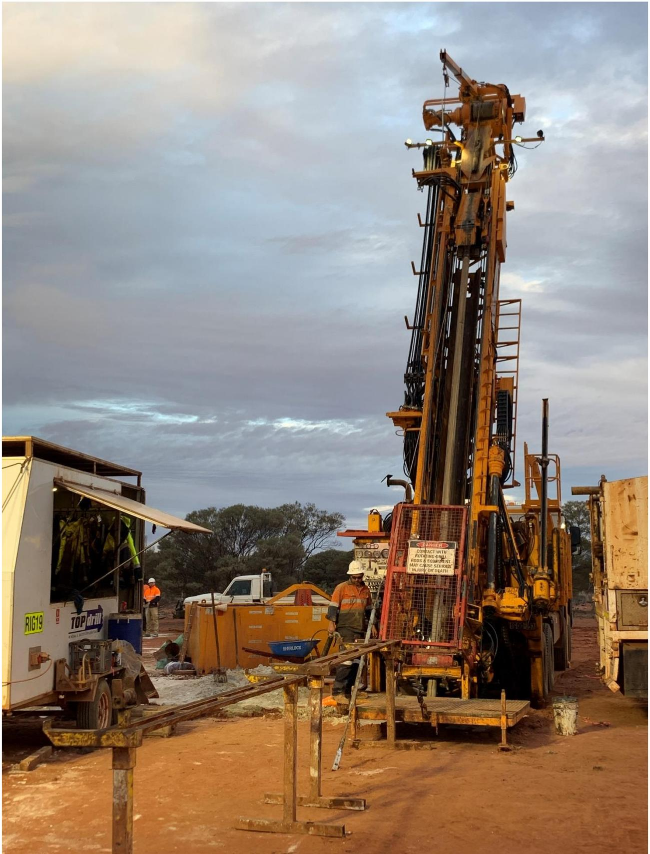
**FIGURE 1: DIAMOND RIG READY TO COMMENCE DRILLING AT MULGA BILL**
